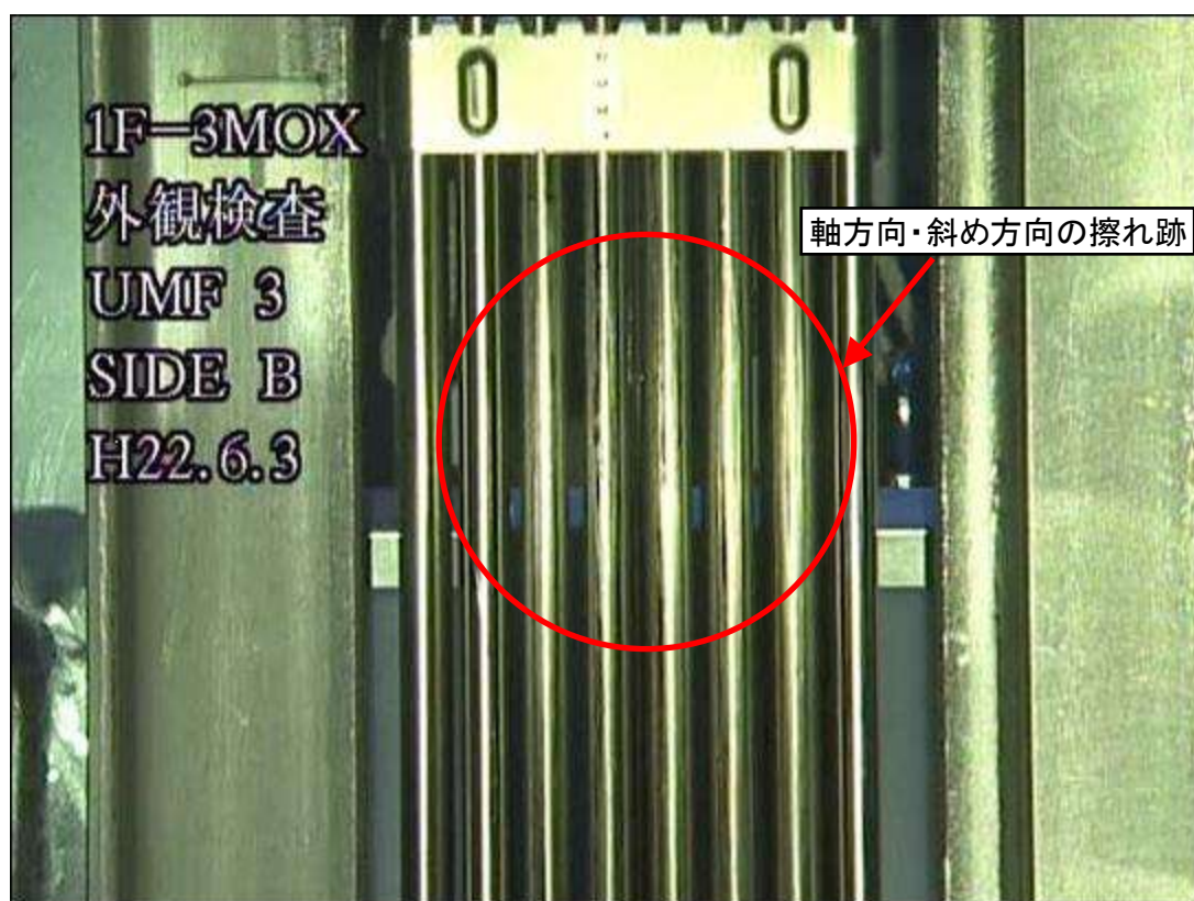
図1-2 UMF3外観確認結果(軸方向・斜め方向の擦れ跡)
